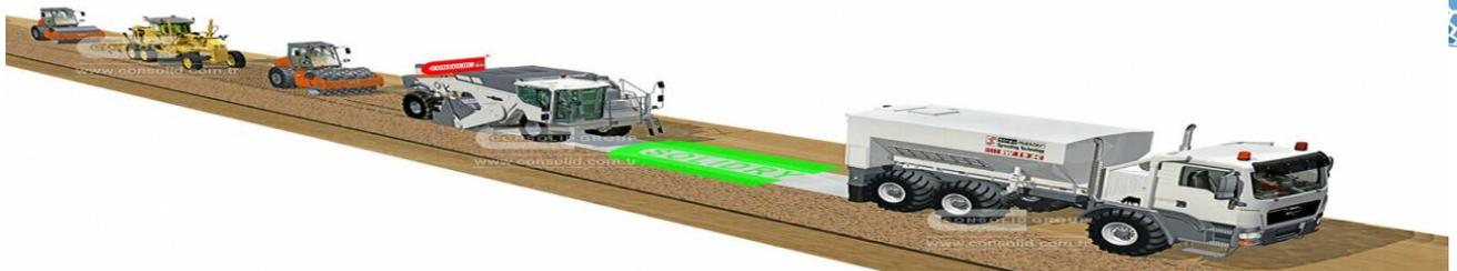
Рис.2 – Укрепление грунтов
